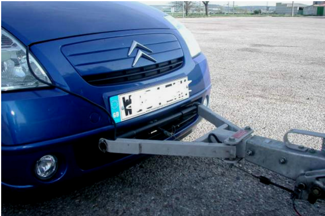
Fotografía número 3.- Sistema de enganche mediante barra fija, desde la autocaravana al chasis del vehículo remolcado (Prohibido).
